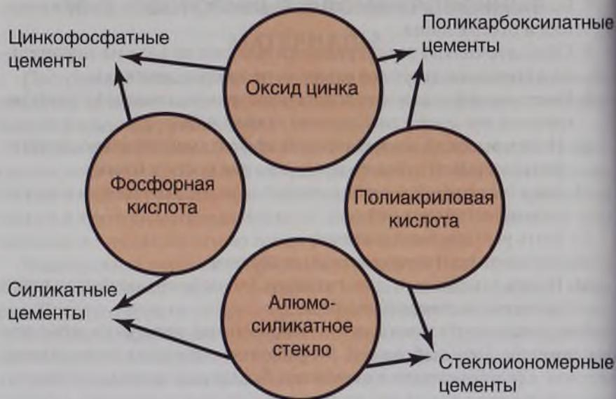
Рис. 10.6. Схема состава цемента
