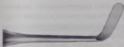
Рис. 3.331. Одноугольная гладилка с округленной рабочей частью
