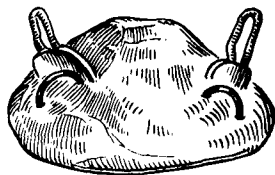
Рис. 61. Расположение деталей в огнеупорной массе для спайки.
