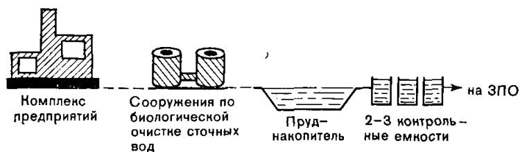
Рис. 11. Движение промышленных стоков на сельскохозяйственные поля орошения (схема).
