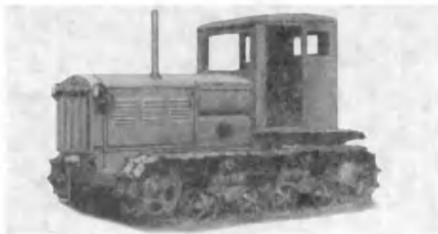
1.6- rasm. SXTZ-NATI rusumli Rossiyada loyihalaniib ishlab chiqarilgan zanjirli traktor.
