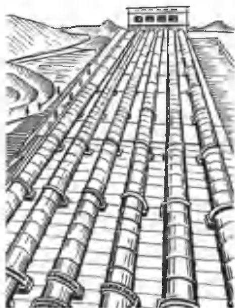
44-rasm. Suvni nasos stansiyasi yordamida yuqoriga ko'tarib berish.
