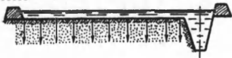
19-rasm. Chek olib bostirib sug'orishda tuproqning namiqish konturi.
