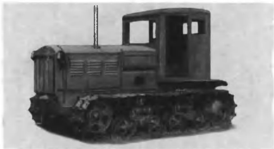
1.6- rasm. SXTZ-NATI rusumli Rossiyada loyihalanih ishlab chiqarilgan zanjirli traktor.
