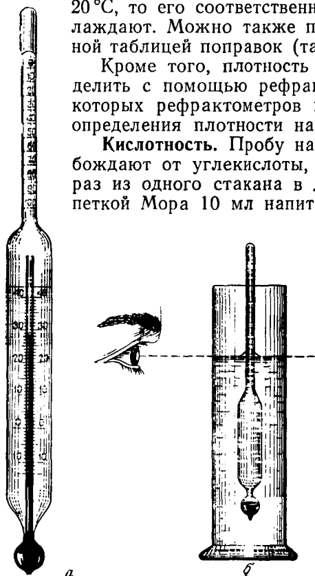
Рис. 32. Сахариметр. а — сахариметр; б — определение плотности напитка.
