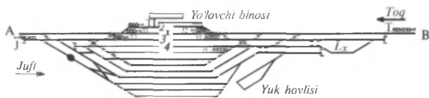
12.9-rasm. Bir yo'llik liniyalarda qabul qilish-jo'natish va saralash parklari parallel joylashgan ko'ndalang turdagi uchastka stansiya chizmasi
